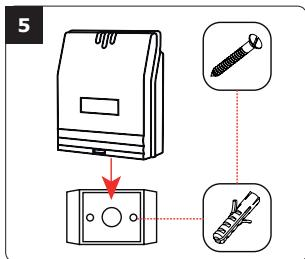
Sätt två plastpluggar i de borrade hålen. Skruva fast styrenhetens monteringsplatta med M4x30 skruvar. Försäkra dig om att styrenheten är upprätt och att den är haka fast vid monteringsplattan.
