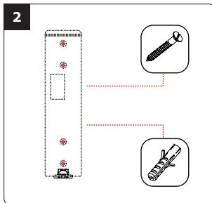
Sæt de 2 plastikplugs i hullerne. Monter låsns bagdæksel med (M4x30) monteringsskruer.
