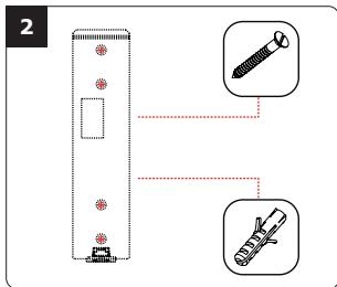
Sätt två plastpluggar i de borrade hålen. Placera kodlåsets bakstycke mot väggen och skruva fast med de bifogade monteringsskruvorna (M4x30).
