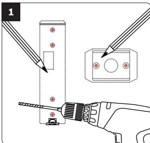
Kontroller afstanden mellem PROFIL100EC-kodelåsen og styreenheden (se side 3, Information og anbefalinger). Anbring låsns bagplade og styreenhedenes monteringsplade på væggen, og marker med en pen hullernes placering. Bor derefter de 2 monteringshuller og hul til kablet ( $\varnothing$  5 mm. bits og min. dybde = 35 mm.).
