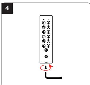
Fastgør PROFIL100EC-tastaturet til bagpladen med den medfølgende (M5x8) Diax®skrue og T20 Diax®nøgle.
