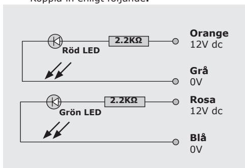
**OBS!** Använd endast 12 Vdc till LED-lamporna.
