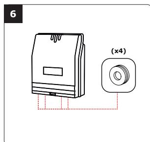
Indsæt kablet i styreenheden og slut det til koblingsterminalerne. Glem ikke at installere varistorer på låsen (se side 22, Information og anbefalinger).
