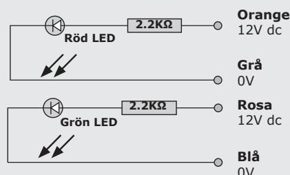
**OBS!** Använd endast 12 Vdc till LED-lamporna.
